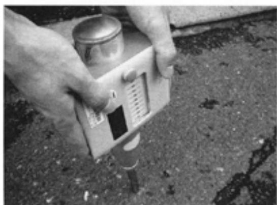
・シュミットハンマー法では基本的にあまり正確に測ることはできず、ばらつきも大きいため、一箇所だけではなく20ポイントで測ることを基本にしているが、鉄筋の真上や骨材の上だと飛びぬけて良い値が取れる。
