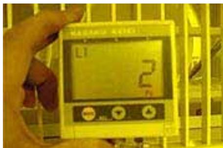
差圧ダンパー越しに隣室との差圧を測定し、調整すると・・・2Pa！
