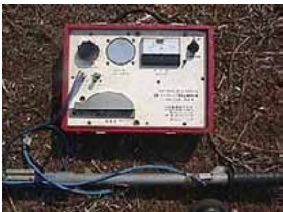
金属探知器のもう一方のデバイス。 これで管路を調査します。
