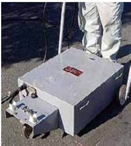
地下レーダー（地中探査機）
