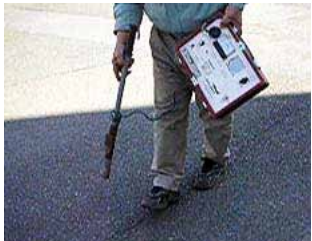
一方を対象の管の地上露出部に取付け、磁波を流し、片方で磁波を探知して調査対象管を追跡できます
