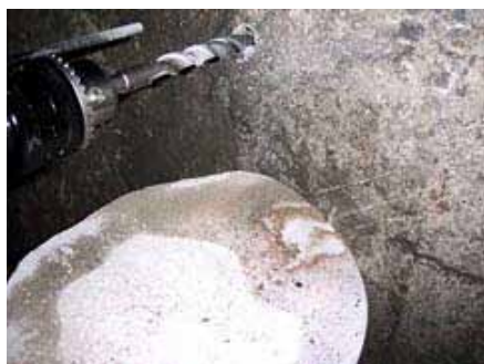
ドリルによる削りクズ採取作業
